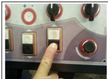
03 – Walze bis auf Min. Höhe bringen. (Walze, bei der die digitalen Einstellungen vorgenommen werden.)
