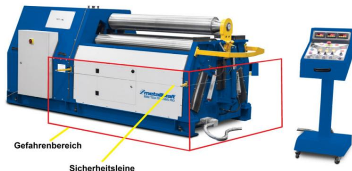
Bild 15: Riskzon på rundbockningsmaskinen
